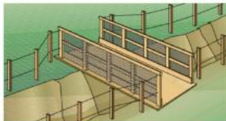
Figura 5 – Passarela na escavação para circulação de pessoas
