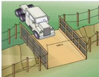
Figura 6 - Passarela para o tráfego de veículos sobre escavação
